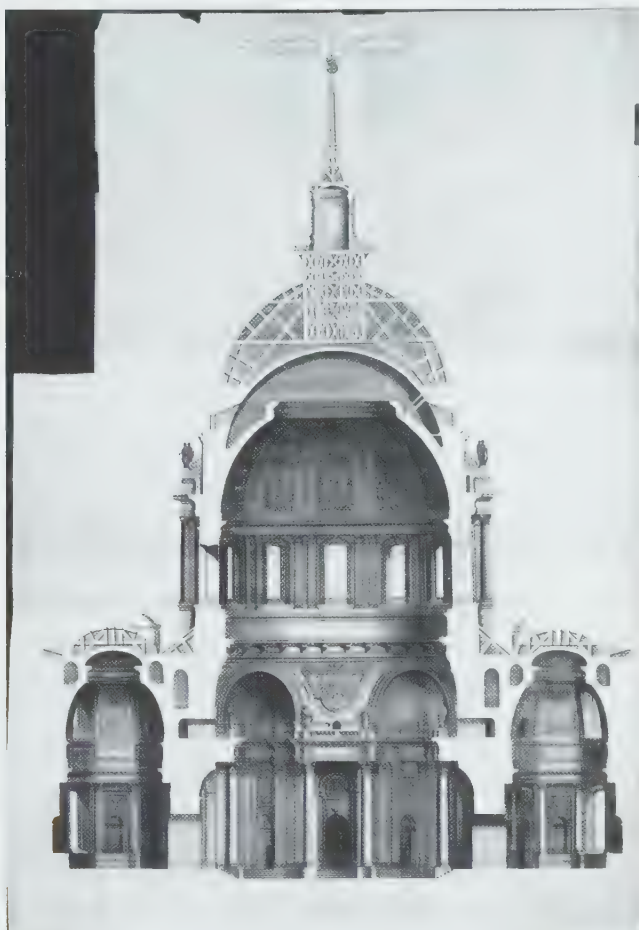
52. Diagonal section of the dome of 'l'église de l'Hostel royal des Invalides', by Pierre Lepautre. 1687. Engraving, 134.5 by 92.5 cm. (Bibliothèque nationale de France, Paris, Va. 444, format 6).
